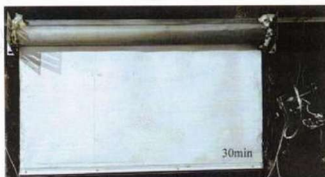
照片 2 耐高温性能试验结束时试件情况
